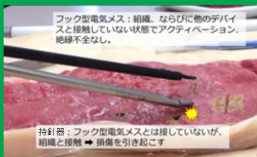
鉗子間距離が非常に近い 単孔式手術の環境下でおこる損傷
