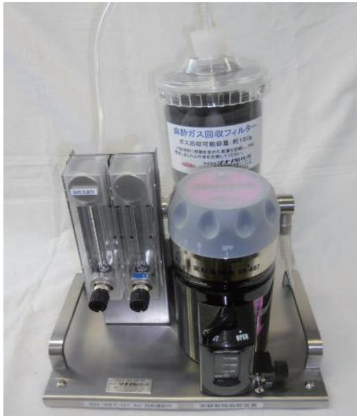
マスクの排気側を麻酔ガス回収フィルターへ接続するだけでは、フィルターの抵抗により回収することができません。SN-487-0T回収機能付きでは、マスクの排気側へエアポンプと流量計が搭載され、マスクからのガス漏れを最小限に抑えます。
